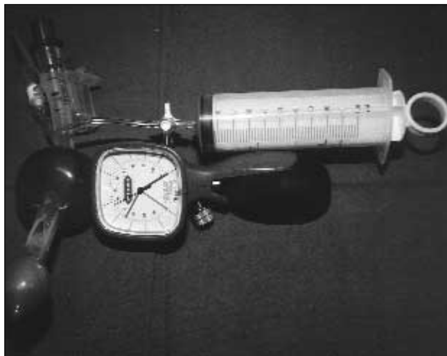
Fig. 4. Método de medida de la compliancia del neumotaponamiento.
